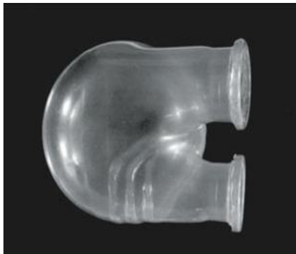
تصویر 11 - بطن دستگاه کمک بطنی ساخته شده از پلی یورتان: علیرغم ضعف‌های سازگاری خون، خصوصیات سایشی و خمشی عالی را نشان می‌دهد.
